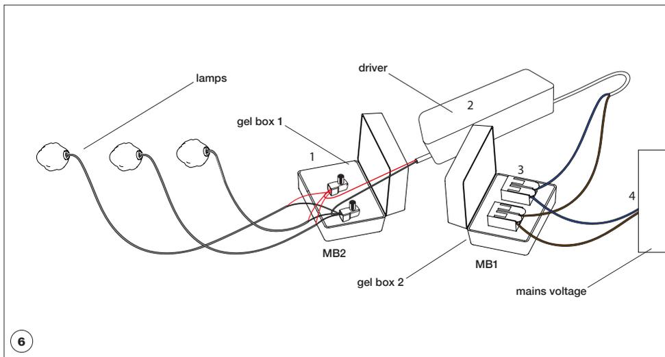
montaggio e sostituzione lampadina / bulb mounting and replacement
